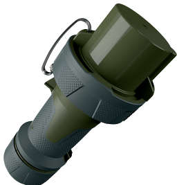
Stekker PowerTOP® Xtra TM met aangespoten rubber greepvlakken, kooiklemmen, hittebestendig binnenwerk, vernikkelde contacten, wartel met afdichting, met afschermkap, behuizing met schroefdraad, vergrendeling voor behuizing en wartel, (vorm CP)
