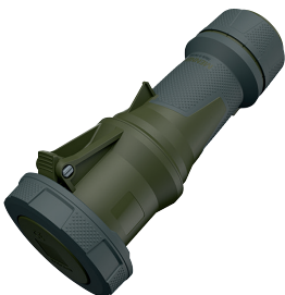
Koppeling PowerTOP® Xtra TM met aangespoten rubber greepvlakken, kooiklemmen, hittebestendig binnenwerk, vernikkelde contacten, wartel met afdichting, met afschermkap, behuizing met schroefdraad, vergrendeling voor behuizing en wartel, (vorm DS)
